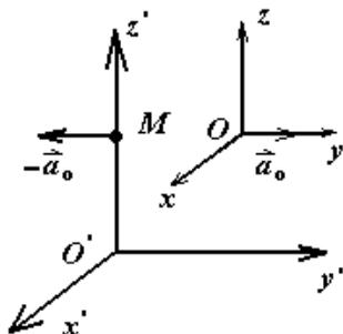
Приведем пример. Пусть точка  $M$  покоится в инерциальной системе отсчета  $x'y'z'$ . А система  $xyz$  пусть движется поступательно с ускорением  $\vec{a}_0$ . Тогда точка  $M$  относительно системы  $xyz$  имеет ускорение  $\vec{a}_M = -\vec{a}_0$ , т.е. в отсутствие внешних сил точка  $M$  относительно
