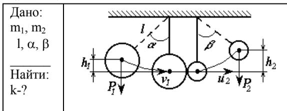
Скорости до удара  $v_1 = \sqrt{2gh_1}; \quad v_2 = 0.$
