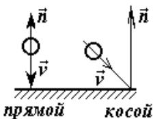
Средняя сила удара  $F_{cp} = \frac{S}{\tau}$ , где время удара  $\tau$  определяется экспериментально.
