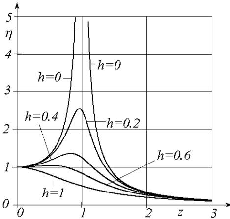
Зависимость динамичности  $\eta$  от отношения частот  $z$  при разных коэффициентах  $h$  показана на рисунке. При равенстве частот ( $z = 1$ ) наступает резонанс. И с уменьшением величины вязкого сопротивления ( $h$ ), относительная амплитуда ( $\eta$ ) будет увеличиваться и при  $h = 0$  стремится к бесконечности.
