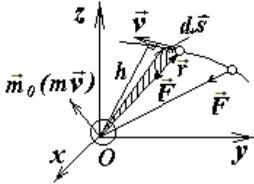
Вектор момента постоянен, т. е. движение под действием центральной силы происходит в плоскости, которая образована радиус-вектором и скоростью.
