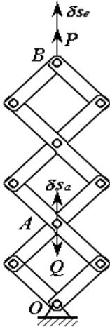
С помощью ПВП можно также решать задачи с трением и находить реакции в неизменяемых механических системах. Сила трения или реакции в этом случае рассматривается как активная сила, а связь отбрасывается. При этом система превращается в изменяемую.
