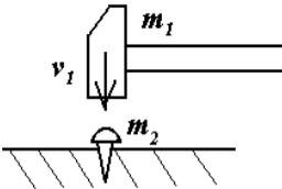
1-ый случай:  $m_1 \gg m_2$ ;  $T_0 - T_1 = \frac{m_2 v_1^2}{2} \approx 0$ ;
