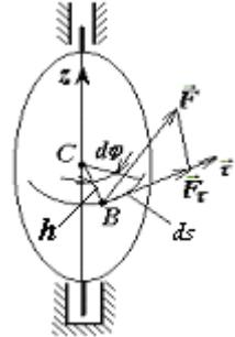
Мощность  $N = \frac{dA}{dt} = M_z \frac{d\varphi}{dt} = M_z \omega$ .
