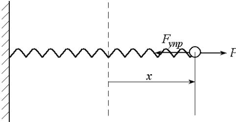
Пусть кроме восстанавливающей силы  $F_{упр}$  на частицу действует постоянная сила  $P$ . Запишем основное уравнение динамики:
