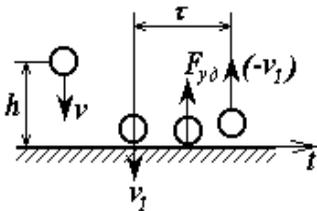
При обычном взаимодействии скорость тел изменяется непрерывно. При ударе скорость тела изменяется скачком. Пример: падение шарика на твердую поверхность с высоты  $h$ . У твердой поверхности шарик приобретает скорость  $v_1 = v + \sqrt{2gh}$  и после воздействия ударной силы  $F_{y\delta}$  его скорость изменится на обратную ( $-v_1$ ).
