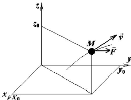
В общем случае силы могут являться функциями координат скорости и времени, например,  $F_x = F_x(x, y, z, \dot{x}, \dot{y}, \dot{z}, t)$ . После интегрирования (2.10) получаем закон криволинейного движения точки
