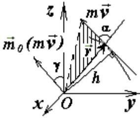
**Моментом количества движения материальной точки относительно некоторого центра  $O$**  называется векторное произведение радиус – вектора материальной точки на вектор ее количества движения:
