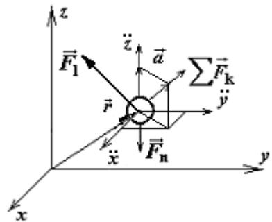
$$1) \quad \vec{v} = \frac{d\vec{r}}{dt}; \quad \vec{a} = \frac{d^2\vec{r}}{dt^2}; \quad m \frac{d^2\vec{r}}{dt^2} = \sum \vec{F}_k \quad - \text{ в векторном виде;}$$
