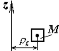
**Твердое тело** – непрерывная система материальных точек с массами  $dm$ , поэтому суммирование заменяем интегрированием по всей массе  $M$  или объему  $V$  системы:
