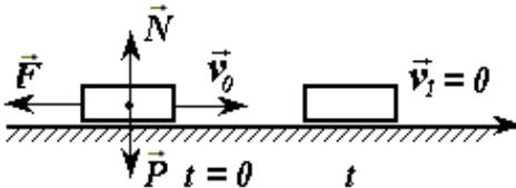
Пример 2. Определить время торможения груза  $m$  постоянной силой  $F$ , который в момент  $t = 0$  имеет скорость  $v_0$  (вторая задача динамики).
