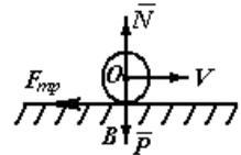
При качении без скольжения по абсолютно твердой поверхности работы сил трения равны нулю.
