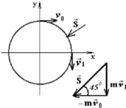
Пример 1. Определить импульс силы при равномерном движении частицы за время прохождения четверти окружности (первая задача динамики).
