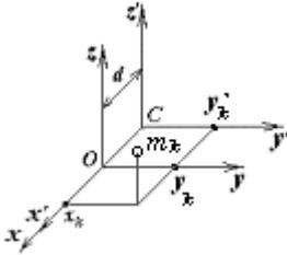
Так как момент инерции определяется квадратом расстояния до оси, то он зависит от положения оси. Рассмотрим, в каком соотношении находятся моменты инерции относительно двух параллельных осей, одна из которых проходит через центр масс  $C$ . Запишем моменты инерции относительно осей  $Oz$  и  $Oz'$ :
