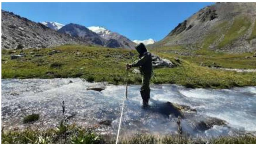
Рис. 7. Измерение расхода воды на ручье в северном Тянь-Шане.
