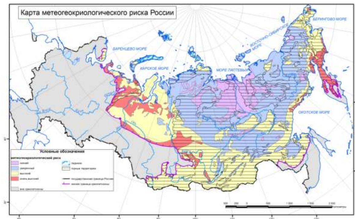
Карта районирования территории России по метеорологическому риску для мёрзлых толщ (красный цвет – максимальный риск, фиолетовый – минимальный)
