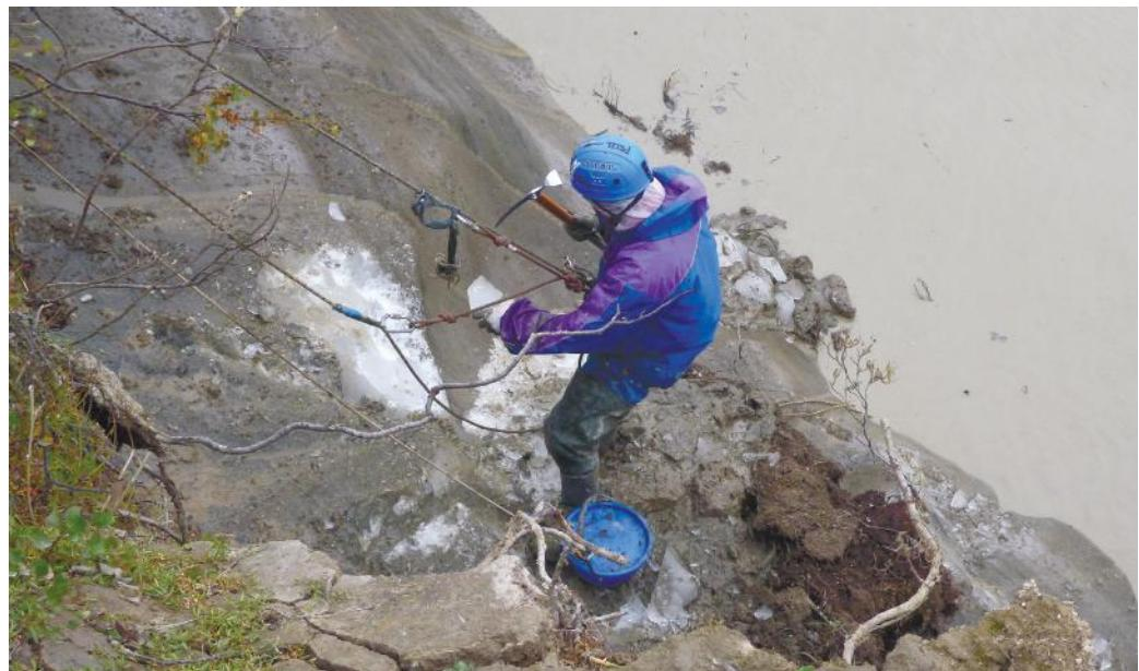
Фото 3. Отбор монолитов пластового льда из стенки ямальской ВГВ-1,
