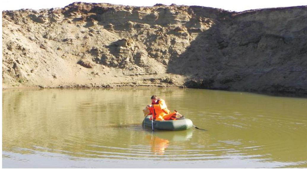
Фото 5. Батиметрическое обследование озера Антипаютинской воронки
