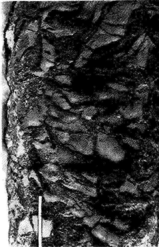
Фото 7.12. Базальная криотекстура суглинка в верхней части разреза II морской террасы (скв.61, мыс. Харасавэй).
